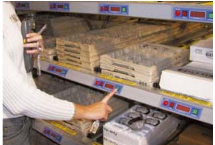
**Beim ‚Pick to Light‘ wird das Personal durch Lichtsignale unterstützt. Arbeitsschritte werden per Tastendruck bestätigt**
