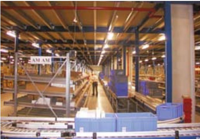
**Das Herzstück des ‚Eurodome‘ ist die Kommissionierzone, die mit einer modernen Pick-to-Light-Anlage ausgestattet ist**
