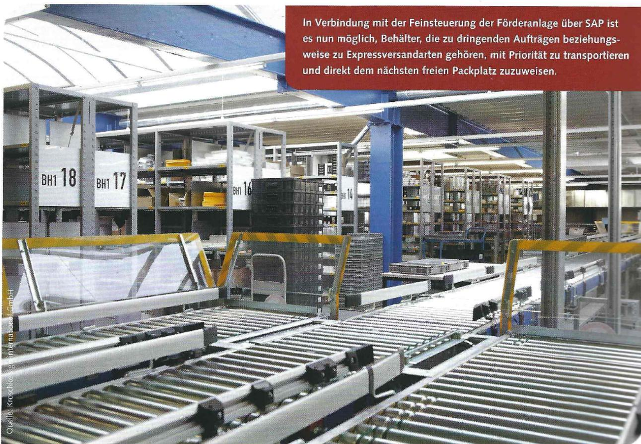
In Verbindung mit der Feinsteuerung der Förderanlage über SAP ist es nun möglich, Behälter, die zu dringenden Aufträgen beziehungsweise zu Expressversandarten gehören, mit Priorität zu transportieren und direkt dem nächsten freien Packplatz zuzuweisen.
